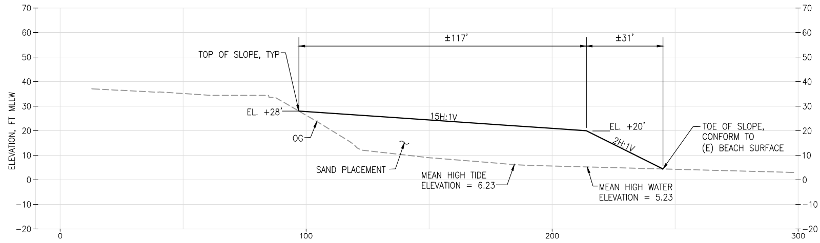
B SECTION - STA 25+25 (S-LINE) C-02.2 SCALE: 1" = 20'
